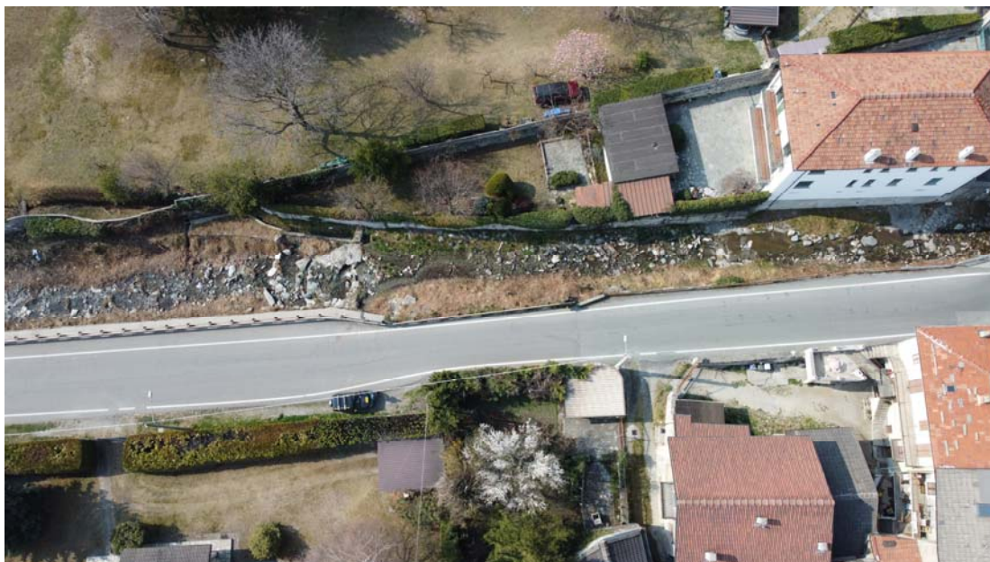
Vista dall'alto della strozzatura determinata dalla casa e dal muretto in cls. in sponda destra
