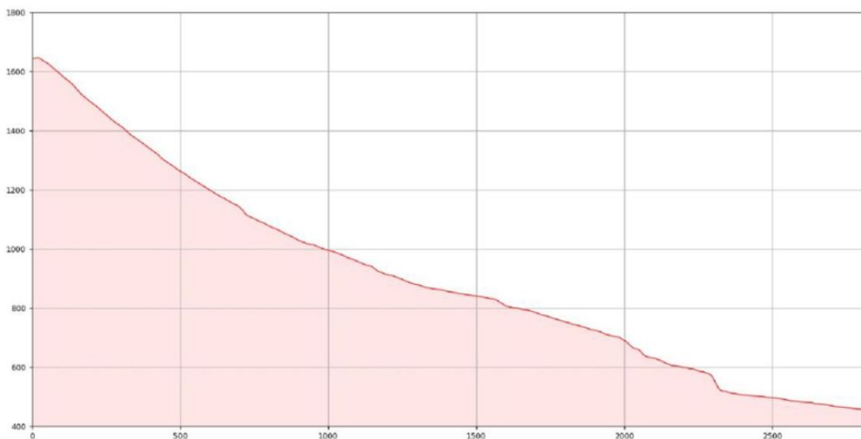
Figura 5: Profilo altimetrico dell'incisione principale del bacino del Rio Comba delle Foglie.
