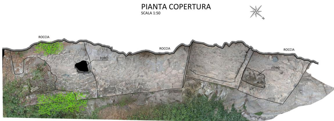
Si osservano dei crolli di alcune porzioni delle coperture e della parte del primo edificio. Si segnala la presenza di vegetazione che nel corso del tempo potrebbe deteriorare le varie parti radicandosi.
