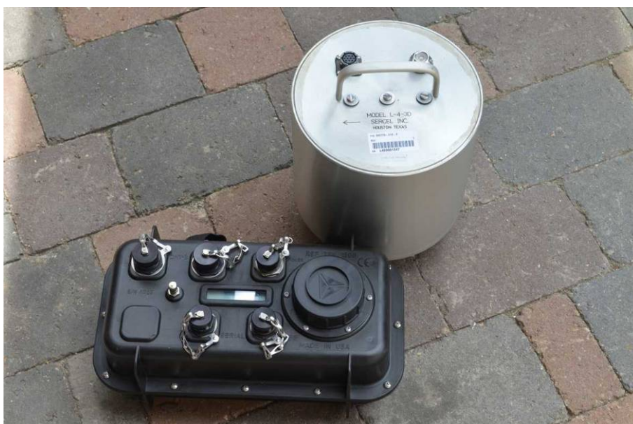
Figura 10 – Sismometro triassiale Sercel L4C-3D con acquisitore Reftek PFC_130B.
