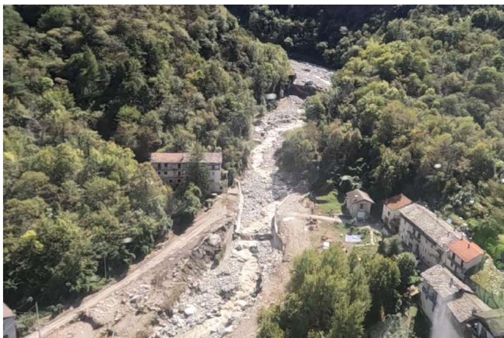
Figura 27. Vista da elicottero della parte alta della frazione Giordani, in centro alla foto le spallette del ponte asportato, subito a valle le erosioni che hanno danneggiato le difese spondali, nella parte alta si riconosce la briglia di quota 710, con un grande blocco depositato sull'orlo.
