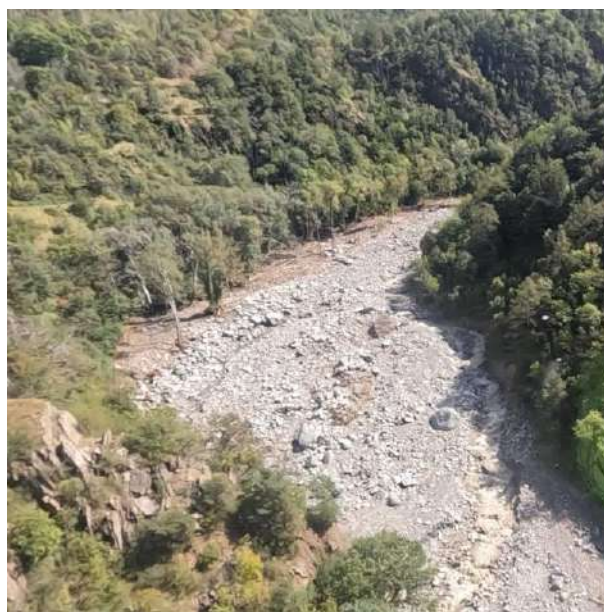
Figura 26. A sinistra: blocchi plurimetrici trasportati e depositi in alveo a circa 2000 m di quota. A destra: alluvionamento e colmamento dell'area di trattenuta a monte della briglia di quota 710 m.
